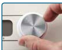
**Generación de energía por rotación.**
